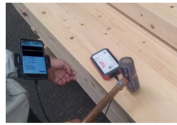
センサーを置いて木口を打撃。 置けない場合は原木センサーを取り付け打撃。
