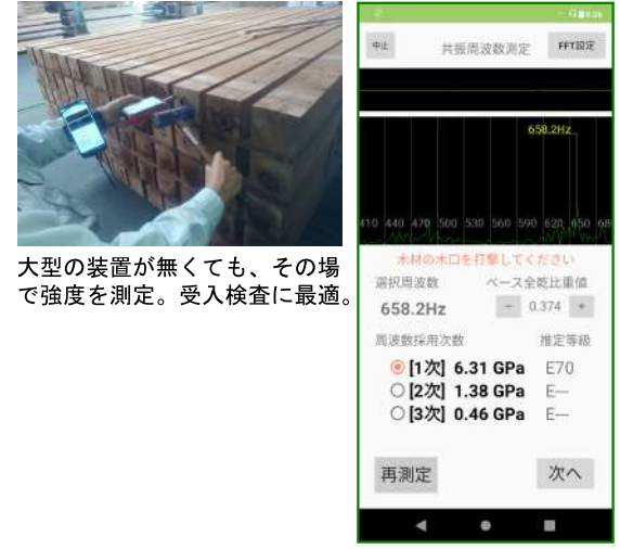
センサーを置いて木口を打撃。 置けない場合は原木センサーを取り付け打撃。
