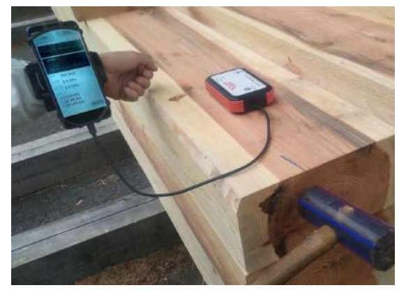
センサーを置いて木口を打撃。 置けない場合は原木センサーを取り付け打撃。
