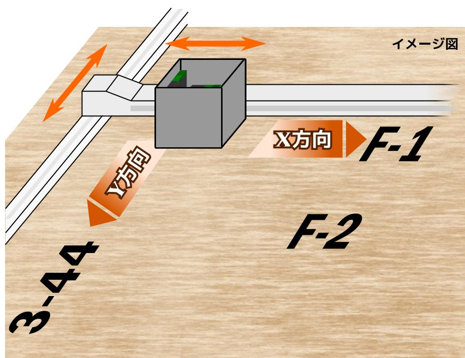
※ Y方向への印字は、X方向に印字をするカートリッジがあるため、基点の位置が若干ずれます。
