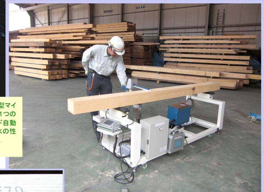
ハンディグレーダ HG-2001 と携帯型マイクロ波水分計 MC-3200 のデータを1つのコントローラで一括処理。印字ヘッド自動移動プリンタで測定材に強度・含水の性能データを任意にプリントできます。
