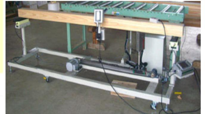
プリンタヘッド自動走行装置と Atajet プリンタ装置及び重量計
