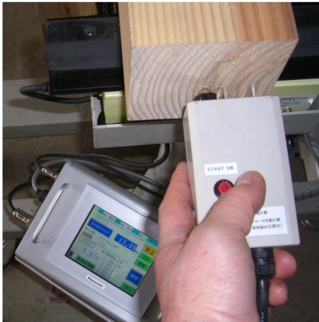
構造材の含水・強度性能は、建物の構造計算にとって非常に重要なことです。品質保証の性能表示は時代のコンプライアンスです。しかし、多品種の製材工場にとってラインにこれらの本格的システムを導入することはスペースの確保と費用の面で大きな障壁があります。そこで製材の含水強度測定の実績を活かしてスペースをとらず必要ときにすぐに利用できる小ロット多品種の工場向けの木材
